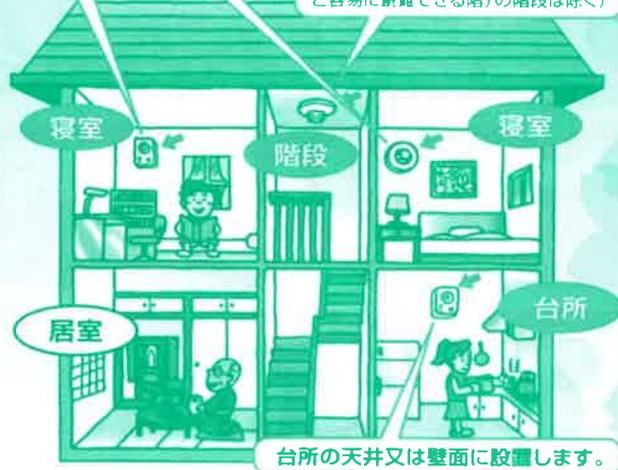
台所の天井又は壁面に設置します。
