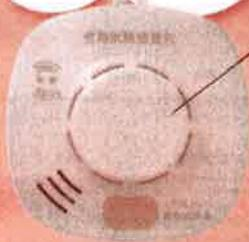
火災警報器には「熱」や「煙」を感知するセンサーが付いています。長期間の御使用により「ホコリ」や「汚れ」でセンサーの感度が低下し誤作動の原因となります。
