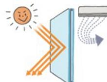
高度の低い西日は軒やひさしでは遮りにくいので、夏の強い日差しをカットする「日射遮蔽型」のガラスが適しています。
