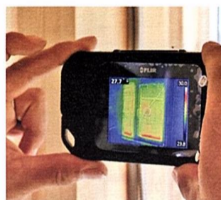
室内からガラスの表面温度を測定すると、シャノンウインドSPG（左）はトリプルシャノン（右）よりも室温に近い
