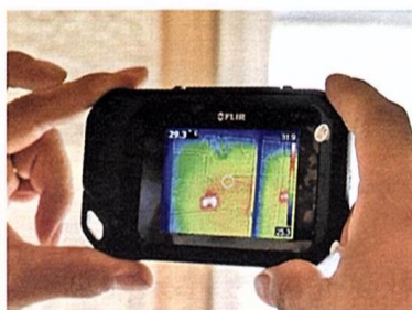
室内からガラスの表面温度を測定すると、シャノンウインドSPG（左）はトリプルシャノン（右）よりも室温に近い
