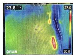
床下エアコンの試験運転の様子。エアコンから最も速い箇所のガラリから計画通り暖気が出ている
