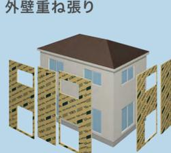
既存住宅の外装の上から断熱・外装施工
