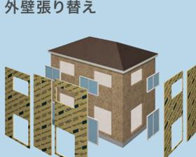
既存住宅の外装を撤去して断熱・外装施工
